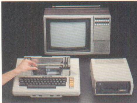
**2** Das Plattenlaufwerk einschalten. Beim ersten Einschalten ist ein schwirrendes Geräusch zu hören, das nach einem kurzen Augenblick aufhört. Das BUSY-Lampe erlischt, doch bleibt die PWR ON (Strom an) Lampe brennen.
