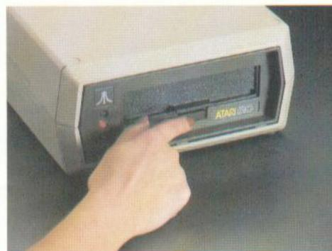
**4** Die ATARI Master Diskette II aus dem Schutzumschlag nehmen, und mit dem Etikett nach oben in das Plattenlaufwerk einführen. Klappe schließen.
